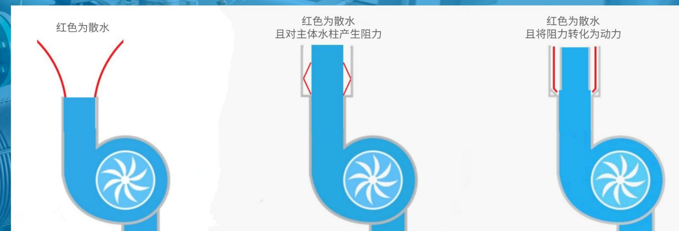
流体导流增压装置工作原理图解
